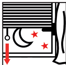
Rys. 4 Należy pamiętać aby grzejniki były odsłonięte. Elementy takie jak długie zasłony, meble, kanapy stojące blisko grzejnika mogą ograniczać dostarczanie ciepła do wnętrza mieszkania.
